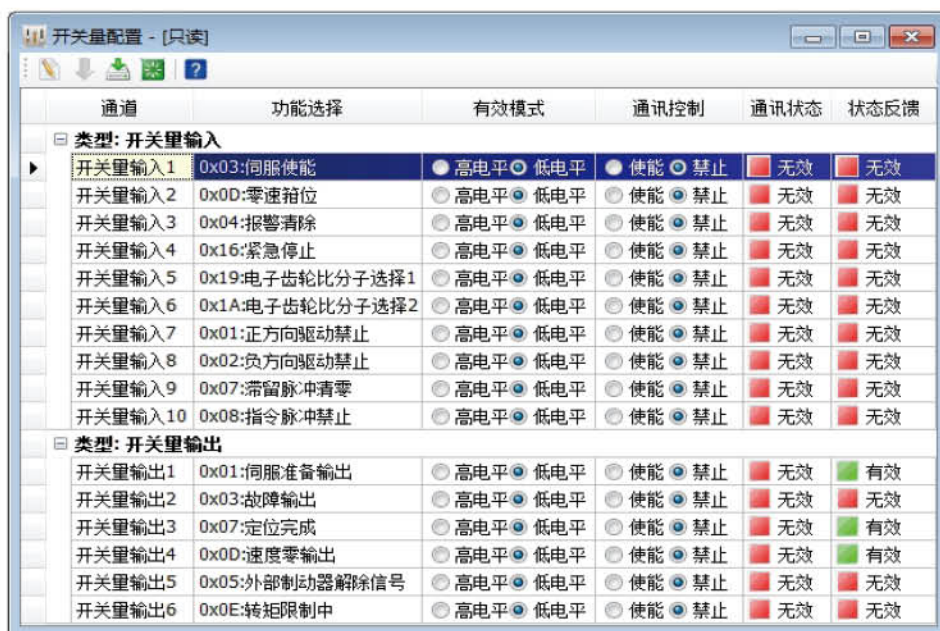
开关量输入、输出可以直接选择端子有效逻辑和功能分配
