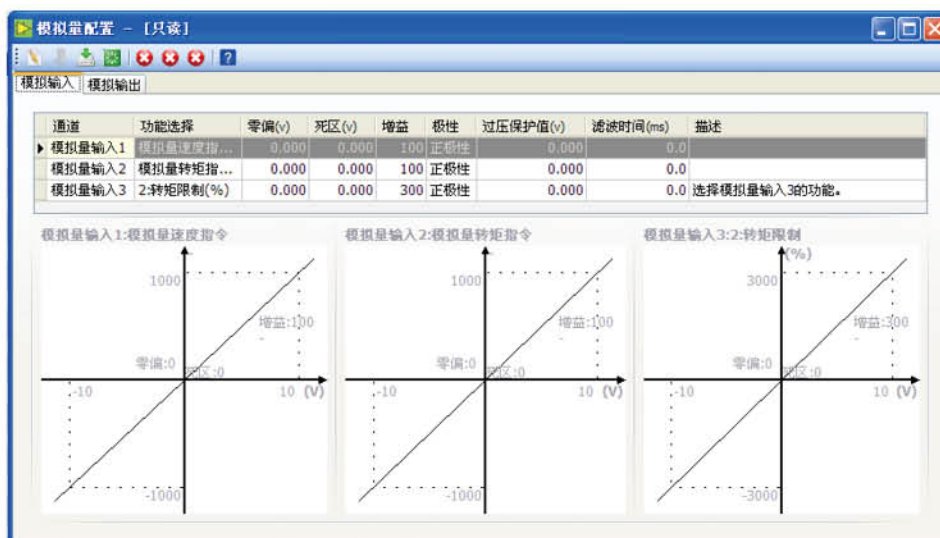
模拟量输入输出可以在图示中设定增益、零偏、死区等参数
